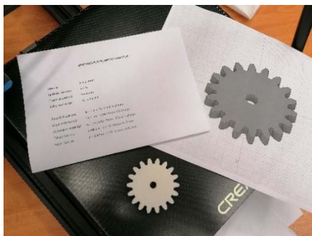
Εικόνα 6. Φωτογραφία του εκτυπωμένου γραναζιού με τις διαστάσεις του
