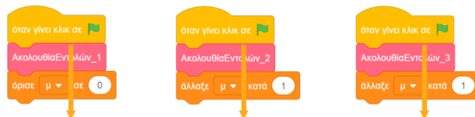
Σχήμα 2: Παράλληλα σενάρια που δεν λαμβάνουν υπόψη τους ότι η εκτέλεση της εντολής "όρισε \mu=0 " ως αρχικοποίηση της τιμής του μετρητή πρέπει να προηγηθεί της εκτέλεσης των εντολών "άλλαξε το \mu κατά 1" των υπολοίπων σεναρίων.
