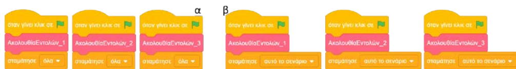
Σχήμα 16. Τερματισμός παράλληλων σεναρίων με το πρόγραμμα να ολοκληρώνεται όταν (α) τερματίσει το πρώτο σενάριο και (β) τελειώσουν όλα τα σενάρια.
