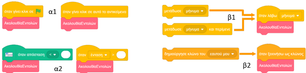
Εικόνα 1. Ενδεικτικά είδη σεναρίων που διαχειρίζονται την ανίχνευση συμβάντων προερχόμενα από εξωτερικές ενέργειες όπως η δράση του χρήστη (α1) ή μιας συσκευής π.χ. ρομπότ WeDo ή μικρόφωνο (α2) και από την αποστολή μηνύματος (β1) ή τη δημιουργία κλώνου (β2).
