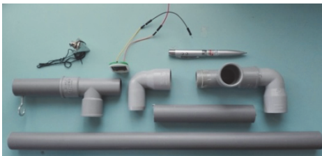
Εικόνα 8. Τα απαραίτητα υλικά και η διάταξη της Φωτοπύλης.
