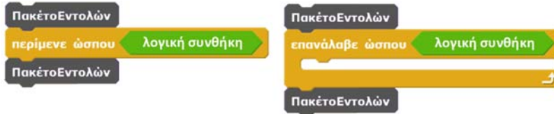
Σχήμα 7. Η υλοποίηση της εντολής "περίμενε ώσπου να ισχύσει μια λογική συνθήκη" με επαναληπτική δομή "επανάλαβε ώσπου να ισχύσει η λογική συνθήκη".
