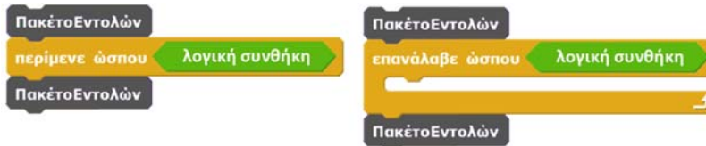
Σχήμα 7. Η υλοποίηση της εντολής "περίμενε ώσπου να ισχύσει μια λογική συνθήκη" με επαναληπτική δομή "επανάλαβε ώσπου να ισχύσει η λογική συνθήκη".
