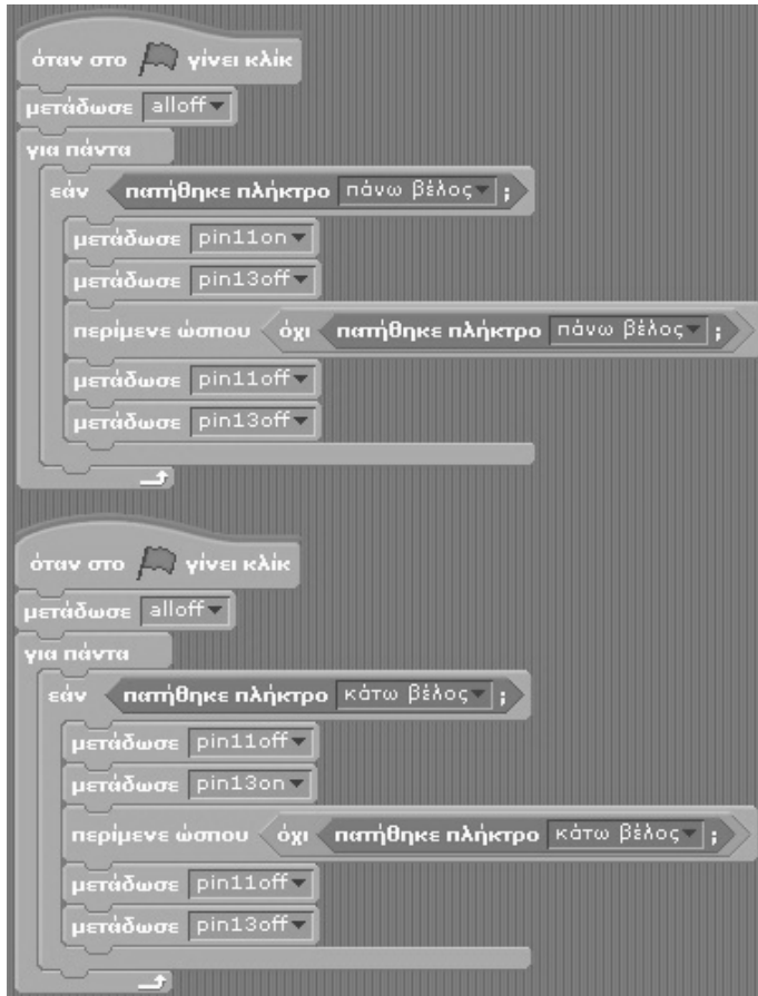
Εικόνα 6. Εντολές χειρισμού κινητήρα DC στο Scratch GPIO.
