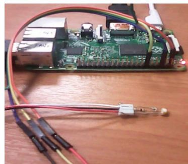
Εικόνα 3. Κύκλωμα LED και έλεγχος μέσω ακίδας GPIO
