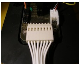
Εικόνα 6. Η πλακέτα του βραχίονα με την απόληξη των καλωδίων του χειριστηρίου αριστερά και χωρίς τα καλώδια, δεξιά.
