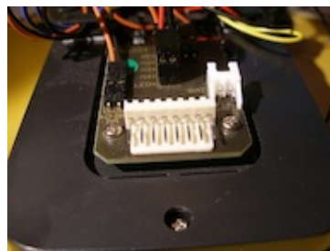
Εικόνα 6. Η πλακέτα του βραχίονα με την απόληξη των καλωδίων του χειριστηρίου αριστερά και χωρίς τα καλώδια, δεξιά.
