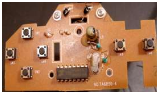
Εικόνα 1. Μπροστινή πλευρά της πλακέτας του τηλεχειριστηρίου. Διακρίνονται οι 6 διακόπτες κατεύθυνσης (SW1-SW6)
